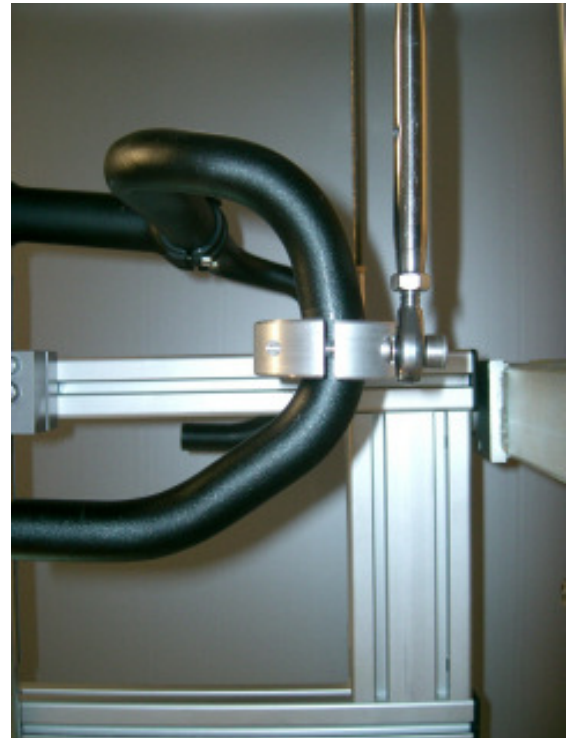
Rennlenker-Lasteinleitung nach EN 14781
