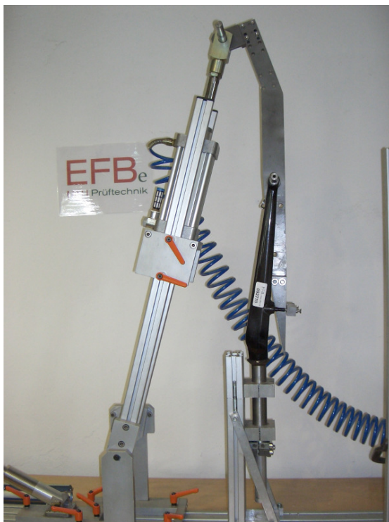
Bild: Überlast- und Maximallastprüfung von Gabeln
