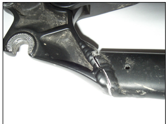
Bild: Service-Bruch im Hinterbau
