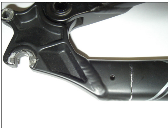
Bild: Prüfstandsbruch bei Bremslast
