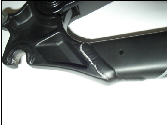
Bild: Prüfstandsbruch bei Achslast
