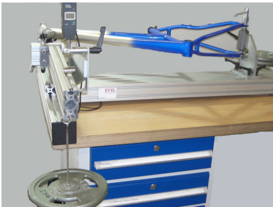
Bild: Spursteifigkeitsprüfung Rahmen-Set
