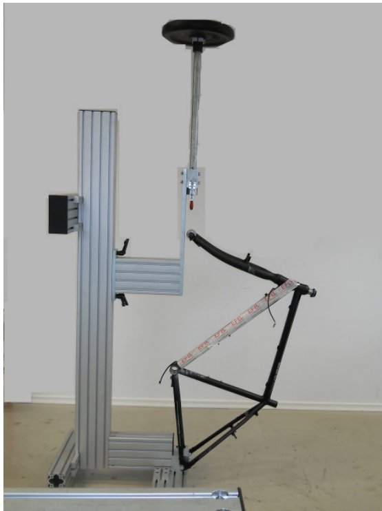
Bild: Prüfung mit fallender Masse
