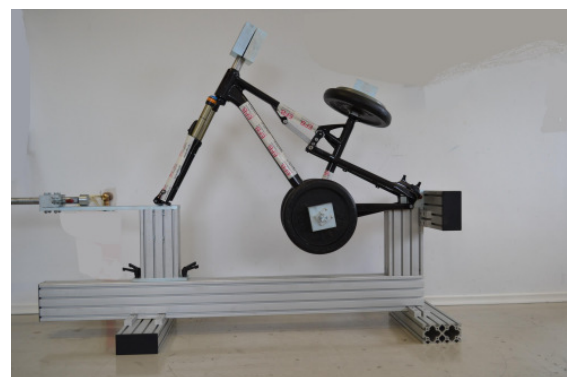
Bild: Prüfung mit fallendem Rahmen
